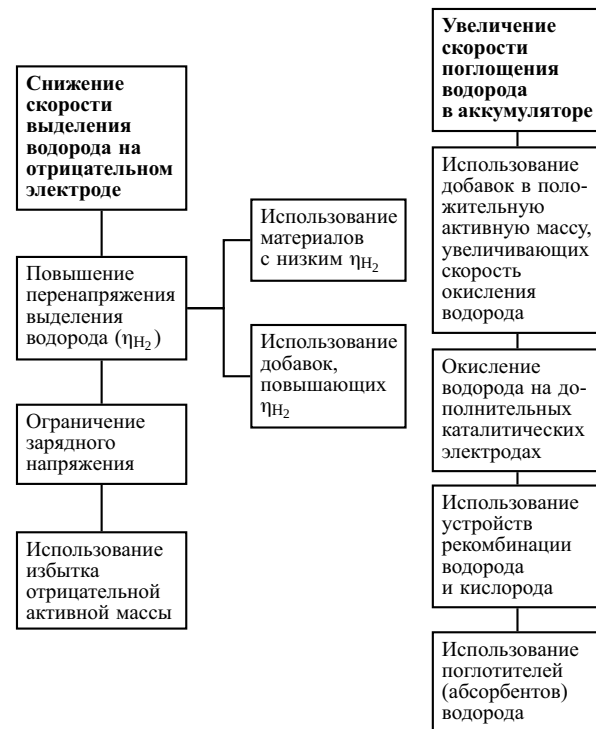
Рис. 8. Мероприятия по снижению перенапряжения выделения водорода и по повышению эффективности его окисления
