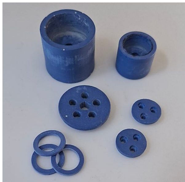
Рис. 1. Изделия, изготовленные методом горячего шликерного литья (цвет онлайн)
