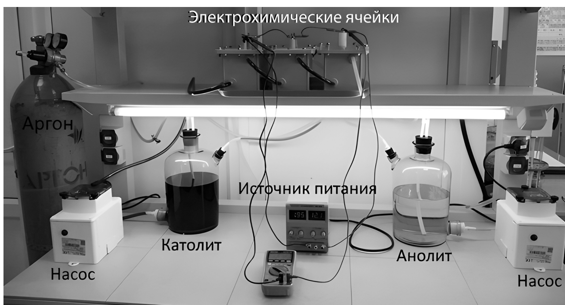
Рис. 11. Лабораторный макет редокс-проточной батареи на основе натриевой соли и антрахинонсульфонокислоты (анолит) и ферроцианида калия (католит) в щелочных растворах с тремя рабочими ячейками
