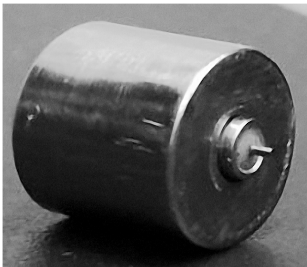
Рис.6. Внешний вид источника тока для гастрокапсулы
